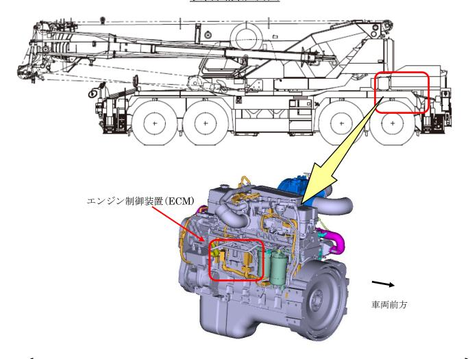
ホイールクレーンのエンジン制御装置(ECM)が、エンジン圧縮開放ブレーキを作動させる信号回路へ誤信号を発するため、エンジン圧縮開放ブレーキが正常に作動しないことがある。そのため、そのままの状態で使用を続けると、エンジン出力の低下若しくは白煙を排出し、最悪の場合、エンジンが停止するおそれがある。
