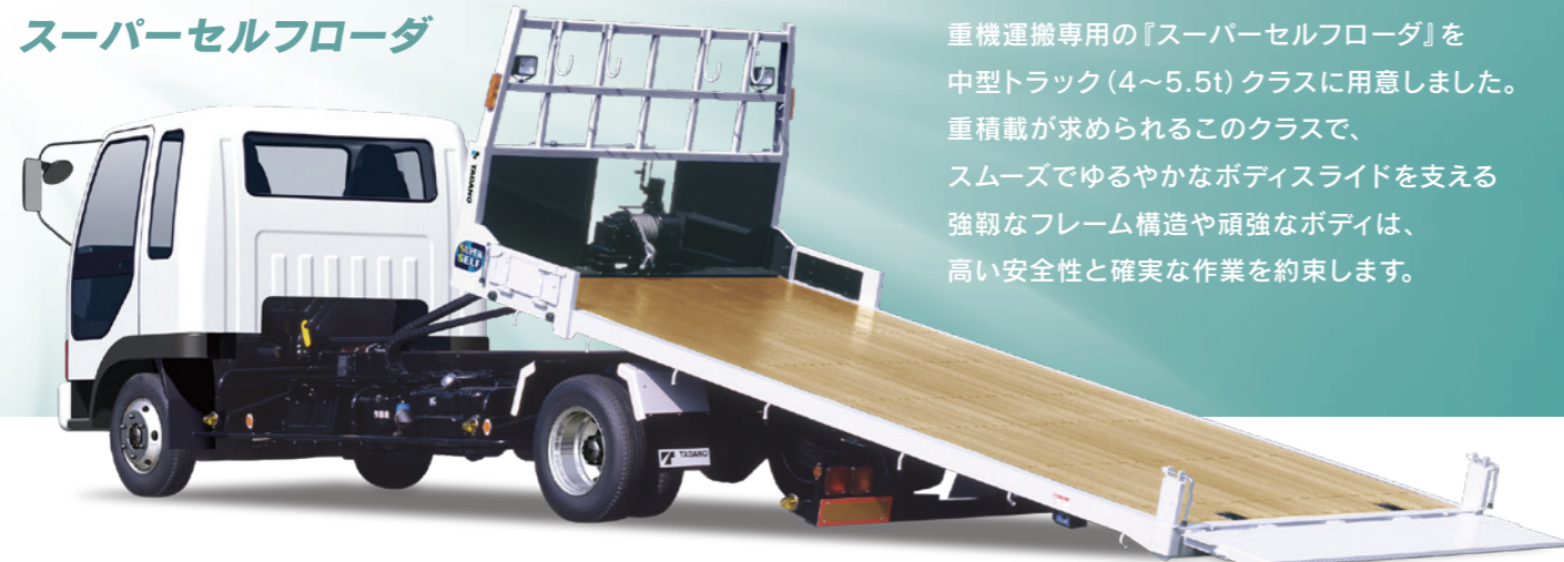
写真は油圧式自動開閉道板 (操作スイッチ付) オプション付です。
