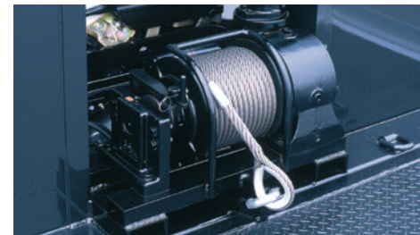
巻上能力: 2t×1本掛け 巻上速度: 5m/min (ポンプ回転数500rpm時)
