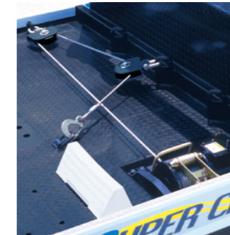
巻上能力: 1.25t×1本掛け 巻上速度: 3.5m/min (ポンプ回転数500rpm時)
