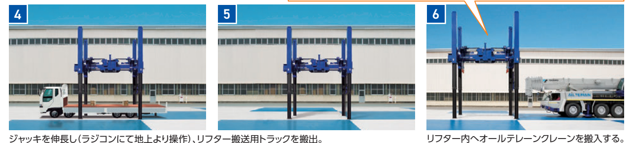
ジャッキを伸長し(ラジコンにて地上より操作)、リフター搬送用トラックを搬出。
