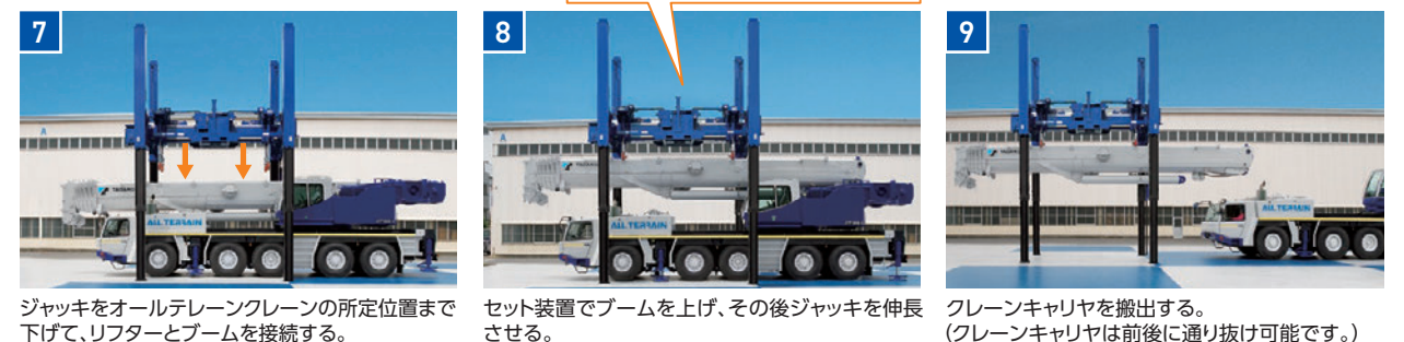
ジャッキを伸長し(ラジコンにて地上より操作)、リフター搬送用トラックを搬出。
