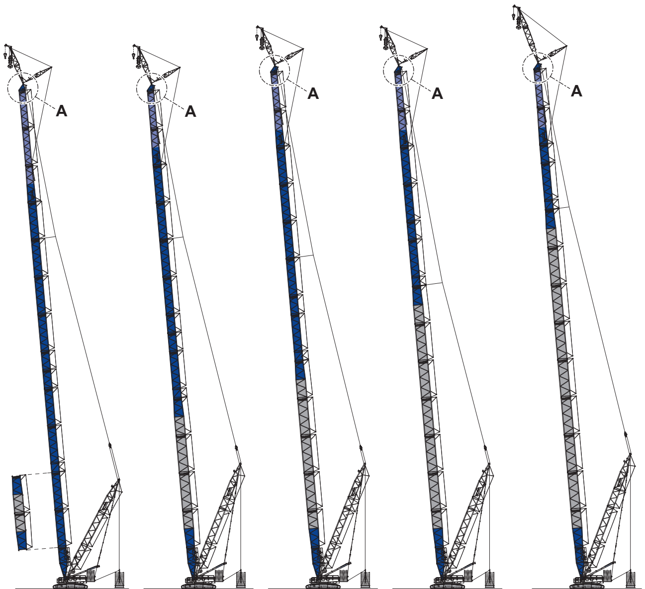
SL付き 固定式フライジブ LSL+LF_6 HA 90m - 159m HI 12m MA 36m
