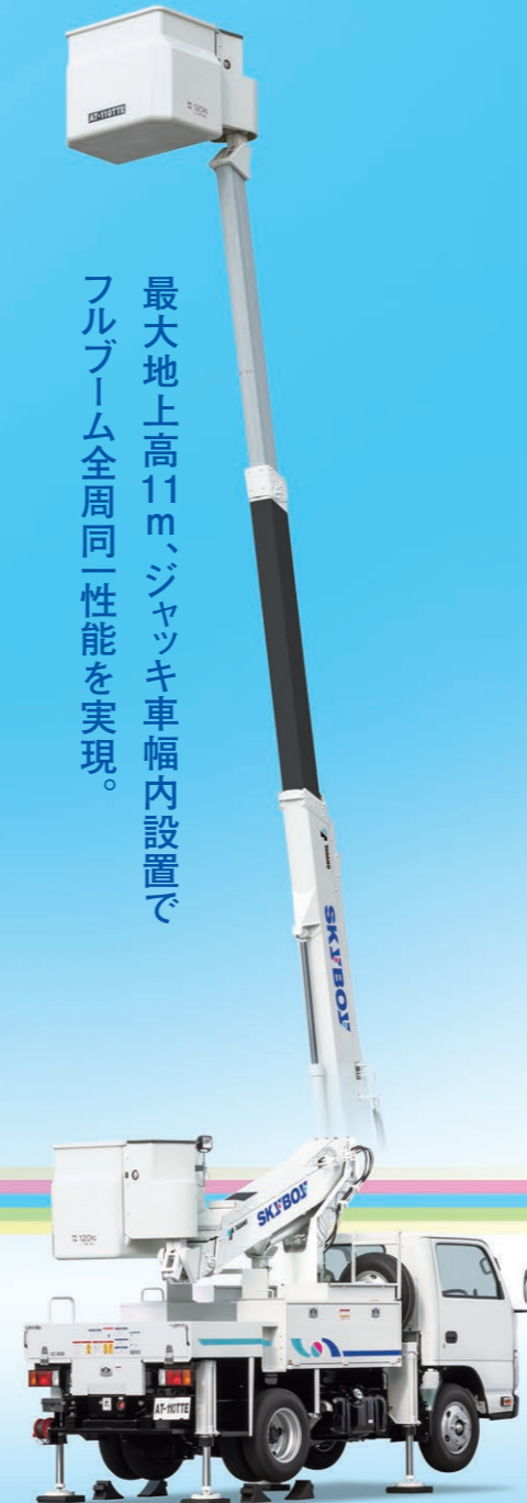
AT-110TTE (S) 最大地上高 11.0m 最大作業半径 8.9m 積載荷重 120kgまたは1名
