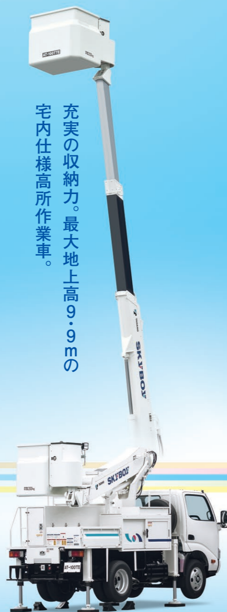
AT-100TTE (宅内仕様) 最大地上高 9.9m 最大作業半径 7.6m 積載荷重 200kgまたは2名
