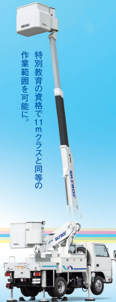
AT-100TTE 最大地上高 9.9m 最大作業半径 8.9m 積載荷重 200kgまたは2名
