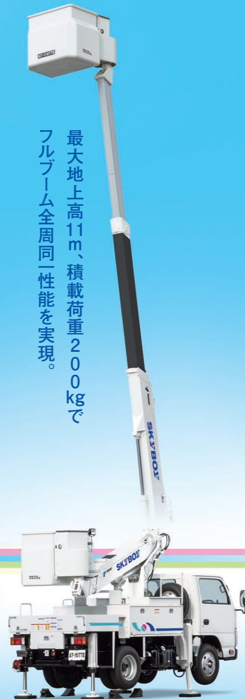
AT-110TTE (D) 最大地上高 11.0m 最大作業半径 8.9m 積載荷重 200kgまたは2名
