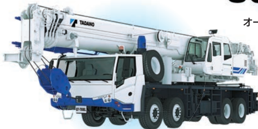
トラッククレーン (建設用クレーン)
