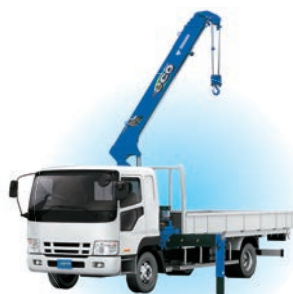
カーゴクレーン (車両搭載型クレーン)
