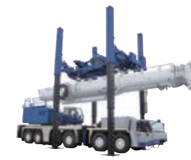
オールテレーンクレーン着脱リフター(ATF400G-6のブーム着脱作業例)
